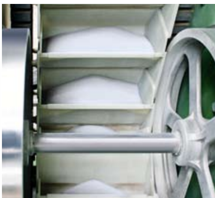
Die Gummiblockketten als Zugträger und das geschlossene Becherband bieten beste Voraussetzungen für den Einsatz in ATEX-Zonen.
