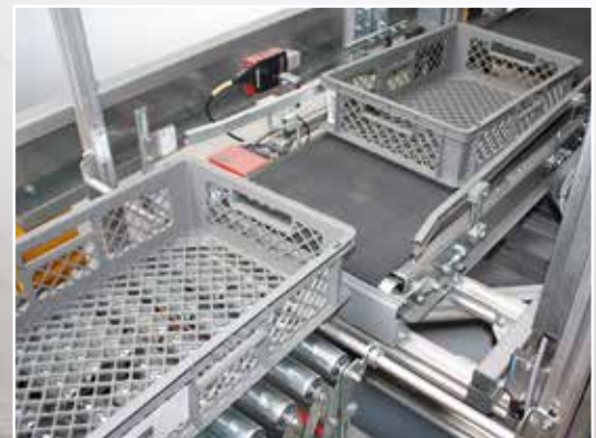
Aufgabestation eines Portalhebers mit Übergabe auf das hier kippbare Eintaktband zur gleichzeitigen Vereinzelung.
