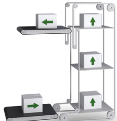
Beim C-Förderer liegen Auf- und Abgabe auf derselben Seite. Das Fördergut wird an der Abgabe durch den rücklaufenden Plattformstrang hindurch gefördert.
