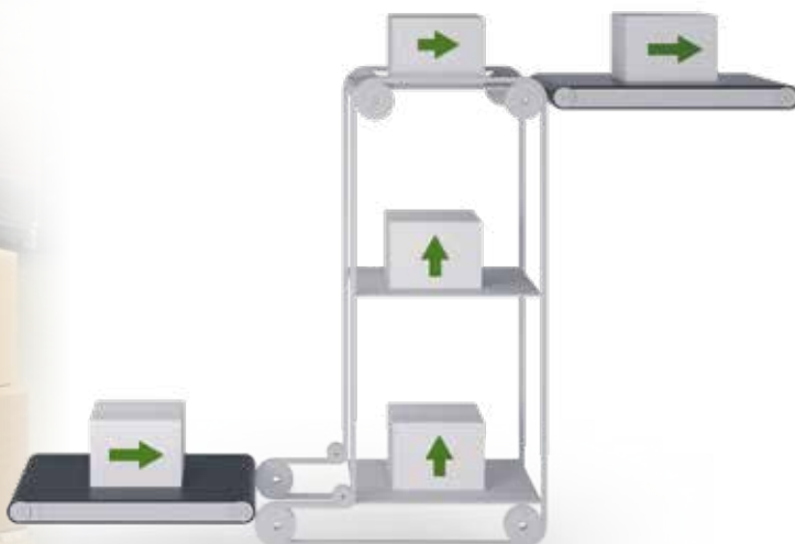
S-Förderer: Optimale Linienführungen der Förderstrecken für die Aufwärts- oder Abwärtsförderung ergeben sich durch die platzsparende Bauweise – zum Beispiel im Vergleich zu Schrägförderbändern.
